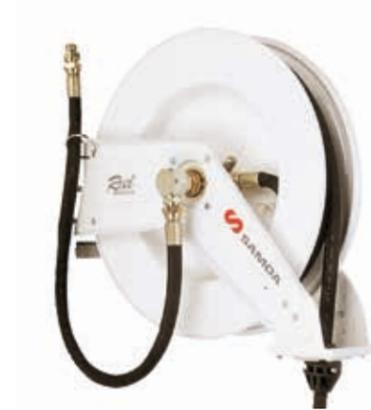
Profi-Schlauchaufroller in solider Stahlkonstruktion mit zwei Führungsarmen, geeignet für Öl, Frostschutz, Fett, Wasser und Luft. Der geschmiedete Messingschaft verhindert Korrosion und Leckagen auch bei Anwendungen im Hochdruckbereich, die Präzisions-Stahlfeder sorgt für problemloses Aufrollen des Schlauchs und lange Lebensdauer.
