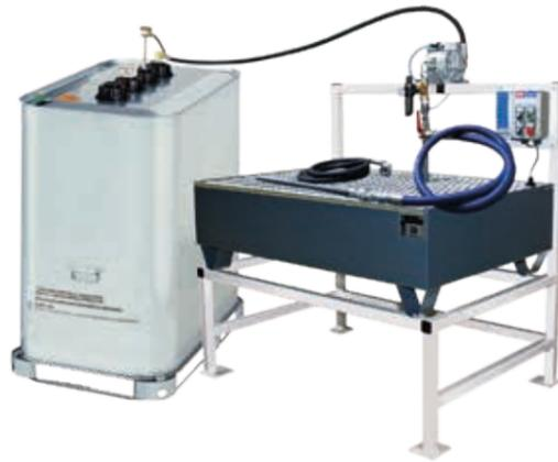
Zentrale Altölsammelstation mit Ablage für överschmutzte Teile wie Ölfilter oder gefüllte Schläuche, zum Entleeren von Kannen, zur Absaugung von Unterfahrwannen etc., mit Füllstandsüberwachung der Sammelstelle und vollautomatischer Entleerung in den ebenfalls überwachten Altölsammeltank. Entspricht der gesetzl. Forderung nach einem gekennzeichneten Lagerplatz.
