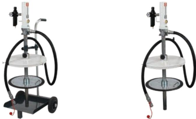
Füllgeräte DPZ für Fette bis Konsistenzklasse NLGI 000 bis 0, auch für Bio-Fette und zähflüssige Öle, einsetzbar in Verbindung mit 15-/18-kg-Eimern, 25-kg-, 50-kg- oder 200-kg-Fässern.
