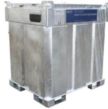
Kraftstoffcontainer IBC für Diesel/Heizöl aus Stahl (S235JR), innen und außen feuerverzinkt. Bauweise: kubisch, doppelwandig, stapelbar, Lecküberwachung nach dem Vakuumprinzip, abschließbarer und federunterstützter Deckel
