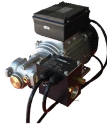
Die elektronische Zahnradpumpe zur Förderung von Frischöl mit internem Bypassventil und Druckschalter ist einsetzbar für Viskositäten bis 2.000 cSt.
