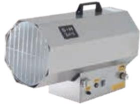
Gasbefuerter Warmlufterzeuger als Vollautomat mit elektrischer Zündung und Ionisations-Flammenüberwachung. Gewerbliches Heiz- und Klimagerät, bautrocknungsg geeignet. Edelstahlgehäuse, inkl. Gasschlauch mit Druckregler für den Anschluss an Gasflaschen von 5 - 33 kg.
