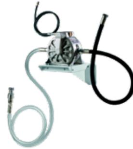
Pumpenset bestehend aus selbstansaugender Doppel-Membranpumpe Directflo® DF100, Wandhalterung, Luftschlauch (1,5 m) mit Schnellwechselkupplung und Luftanschluss, Druckschlauch (1,5 m) sowie Saugschlauch (1,5 m) mit Schnellwechselkupplung zur Entleerung von Altölsammlern und Altölwagen.
