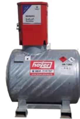
Kraftstoffcontainer für Diesel/Heizöl aus Stahl (S235JR), innen und außen feuerverzinkt. Bauweise: liegend, zylindrisch, doppelwandig, nicht stapelbar, Lecküberwachung nach dem Vakuumprinzip
