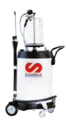
Mobiles Gerät zum Absaugen von Altölen aus allen Fahrzeugen. Absaugung erfolgt durch Unterdruck direkt über die Peilstaböffnung mit Saugsonden bzw. Adaptern. Nach der Unterdruckerzeugung durch die Vakuumpumpe können die Absauggeräte unabhängig vom Druckluftnetz betrieben werden, müssen zur Entleerung des Behälters jedoch wieder an dieses angeschlossen werden.
