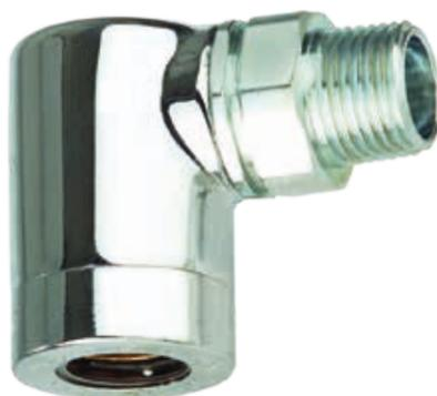
Gassteckdose zum Anschluss von Verbrauchsgeschäften an die Gasversorgung. Inkl. thermisch auslösendem Absperrerelement zum Schutz des Verbrauchsgeschäfts vor unzulässig hohen Temperaturen, sperrt den Durchfluss bei Temperaturen über 100 °C selbsttätig ab. Sichtanzeige rot/grün zur Kontrolle des Betriebszustandes bzw. der Schlauchverbindung. Geeignet für die Aufputzmontage.
