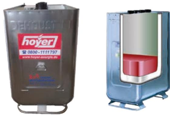
Doppelwandiger Sammel- und Vorratstank, Innenbehälter aus HDPE, Auffangwanne aus beidseitig verzinktem Stahlblech, zur Lagerung von Heizöl, Dieseldieselkraftstoff, Pflanzenölen, frischen und gebrauchten Schmier-, Hydraulik- und Wärmeträgerölen. Im Leerzustand mit Hubfahrzeug beweglich
