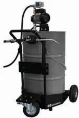
Elektrische Abfüllanlage für Öl mit Fahrwagen, für Fass- bzw. Fahrwagenmontage mit Saugereinheit NW25 und Fußventil, geeignet für kurze Förderstrecken, komplett mit Drehgelenk und Auslaufrohr für Motorenöle.
