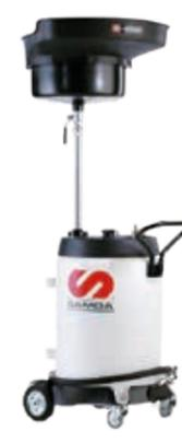
Profi-Altölauffangwagen mit Druckluftentleerung. Bei geschlossenem Kugelhahn kann das Öl über den Schlauch in einen separaten Lagerbehälter umgepumpt werden. Durch zusätzliche Hydraulikkupplungen (Behälter/Tank) kann der Entleerungsvorgang optimiert werden.
