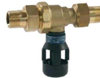
Beim Anschluss von Mischgeräten an die Trinkwasserleitung muss ein Systemtrenner eingesetzt werden.
