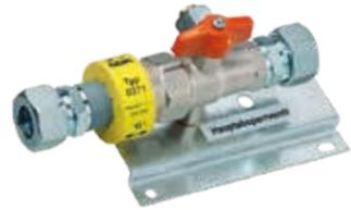
Thermische Absperreinrichtung TAE zum Einbau in Flüssiggasanlagen nach der Hauseinführung. Selbsttätige Absperrung des Gasdurchflusses bei Temperaturanstieg auf über 100 °C, inkl. Isolierstück und Absperrventil. Lieferung **ohne** Grundplatte.
