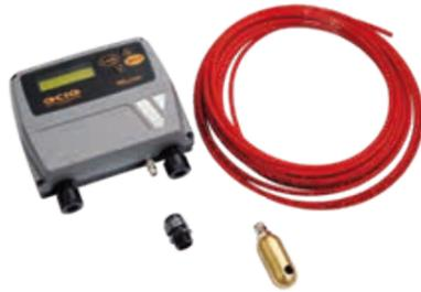
System zur kontinuierlichen Tankstandsverwaltung. OCIO erfasst den von der Höhe der Flüssigkeit erzeugten statischen Druck anhand eines in den Tank eingeführten Schlauches und zeigt den Flüssigkeitsstand oder das Volumen an, wahlweise in Litern oder Zentimetern.
