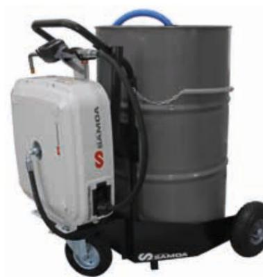
Abbildung zeigt Pumpmaster DP-F 3:1 mit Automatik-Schlauchaufroller
