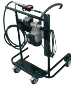
Mobile Einheit zur Umfüllung von Öl, bestehend aus einem fahrbaren Fassträger aus Rohrkonstruktion, komplett mit Pistolenhalter, Schlauchhalter und Tropfensammler. Inkl. Zapfpistole mit biegsamem Endstück und tropfsicherem, automatischem Ventil, inkl. digitalem Zählwerk.
