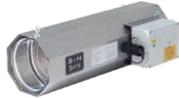
Gasbefuerter Warmlufterzeuger zur Stallbeheizung als Vollautomat mit Infrarot-Flammenüberwachung, elektrischer Zündung und unterstützendem Luftgebläse und offener Verbrennungskammer zum Betrieb ohne Abgasanlage.
