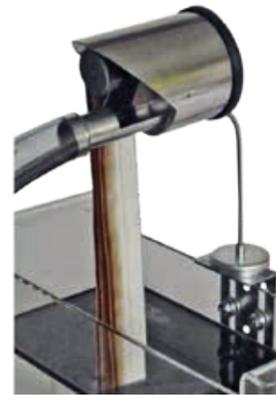
Beim Bandskimmer werden die aufschwimmenden Fremddöle (der Ölfilm sollte geschlossen sein) mittels eines Spezialbandes abgetragen. Der Vorteil gegenüber dem Scheibenskimmer liegt bei dem geringen Platzbedarf und einer höheren Eintauchtiefe. Je nach Ausführung sind bis zu 800 mm möglich.
